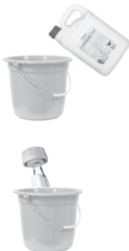
En caso de que la célula presente demasiado calcio y éste no haya podido ser eliminado tras diez minutos en la solución de limpieza, se recomienda el uso de un agente especial para la limpieza de esta y el cual no resulte corrosivo o dañino para ésta. La célula se puede dejar sumergida en el producto limpiador hasta 1 hora y eliminará todo resto de calcio que haya quedado incrustado.
