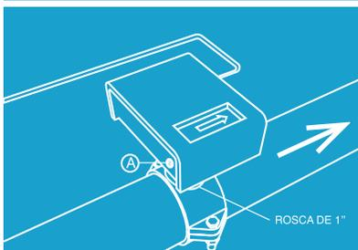
1. El sensor de Flujo se coloca al final del circuito hidraulico, en el caño de RETORNO a la pileta(8)
