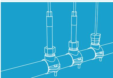
1. Los sensores de Cloro, PH y Temperatura se colocan idealmente entre la bomba y el filtro en POSICIÓN VERTICAL. (ver Sala de máquinas. 4; 5; 6).
