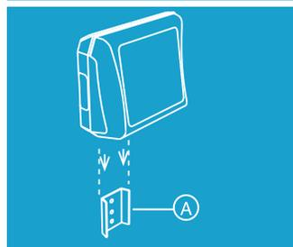
1. Colocar el soporte (A) en la pared con los tornillos provistos.
