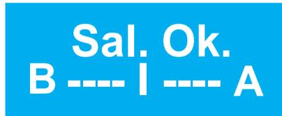
**SALINIDAD OK +:** Cuando la salinidad se acerca al estado A (alto), aparece el signo “+” al lado de SAL OK. Este es un estado previo a la desconexión del equipo por salinidad alta. El equipo notifica esta situación para que el usuario no agregue mas sal al agua.
